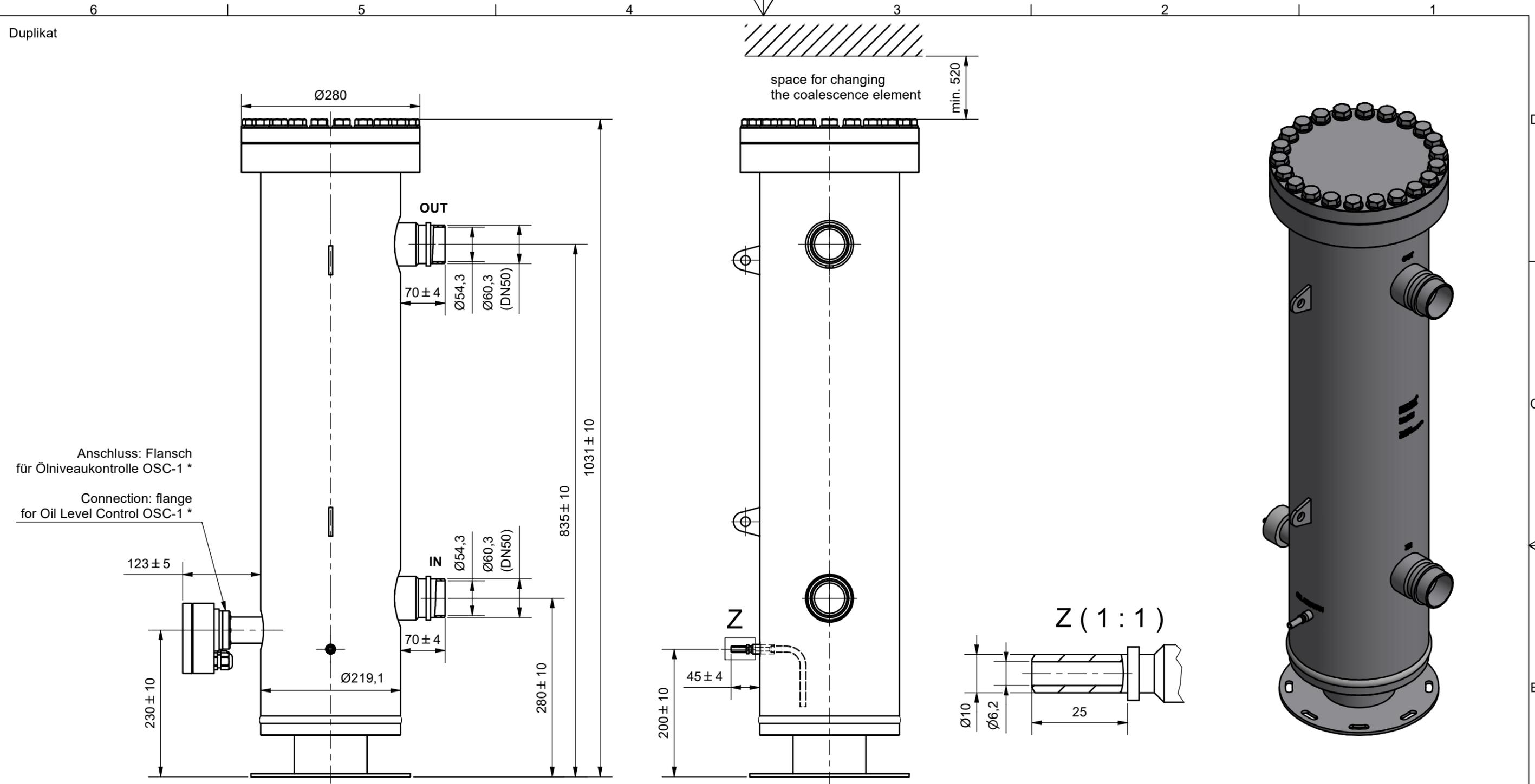
Anschluss: Flansch für Ölniveauekontrolle OSC-1 \*
